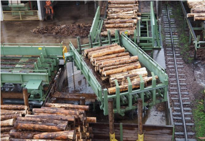
Ein besonderer Clou: Bei der Sägezubringung lässt sich der hintere Teil der Mechanisierung um 90° drehen ...
