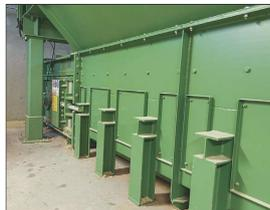
Verstärkung des Kappholz-Kettenförderers mit Stahlträgern und Schwingungsdämpfern
