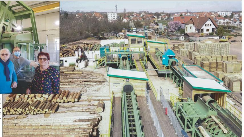
Der neu installierte Rundholzplatz bei Feidt in Molsheim: links die Linie für Langholz, rechts für Abschnitte. Auf dem Null-Niveau des Platzes unterhalb des hier sichtbaren Holzbodens sorgt die automatisierte Entsorgung von Rudnick und Enners nun für einen reibungslosen Betrieb und Sauberkeit.
